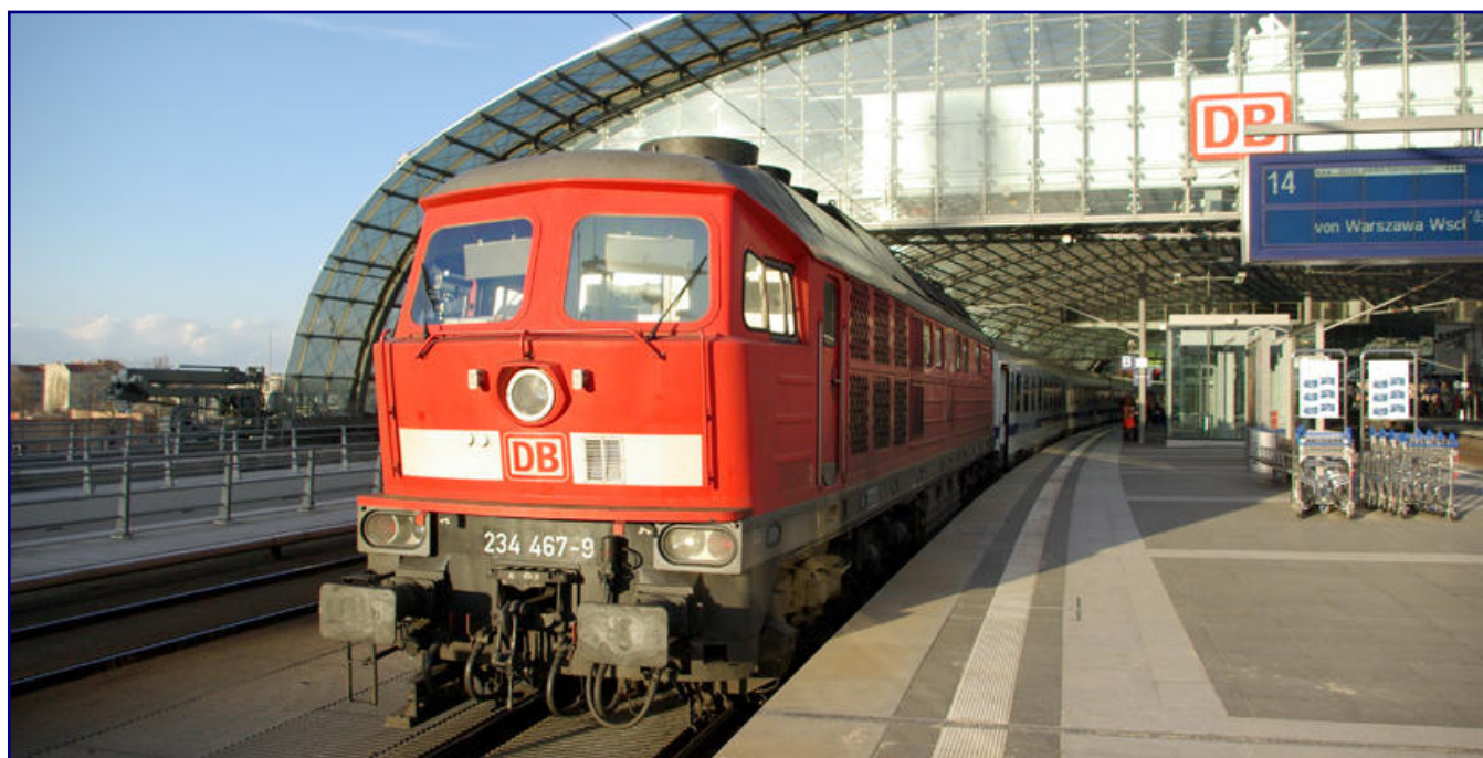
Für den Einsatz im hochwertigen Reisezugverkehr ließ die DR 1991 insgesamt 35 Maschinen zur Baureihe 234 umbauen, die für 140 km/h Höchstgeschwindigkeit zugelassen waren. Sie kamen auch bei der DB AG noch zu Fernverkehrseinsätzen: 234 467-9 ist am 26. März 2008 soeben mit einem Eurocity aus Warschau in Berlin Hbf angekommen. Foto: Johannes Fielitz (GNU)
